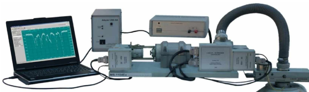
Рис. 2.10. Зображення месбауерівського спектрометра з азотним кріостатом MS-1104Em
