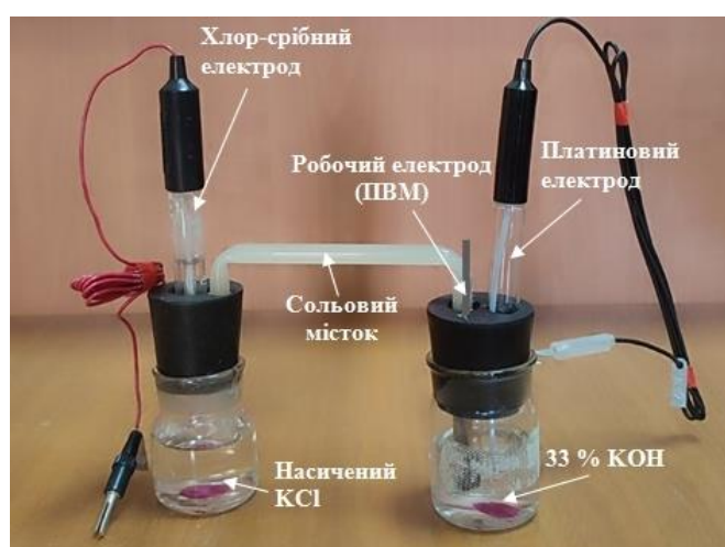
Рисунок 4.13. Конструкція трьохелектродної комірки для електрохімічних досліджень ПВМ
