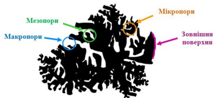
Рисунок 2.1. Схематичне зображення пористої структури ПВМ [88]
