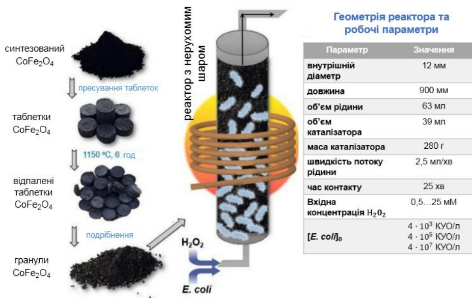
Рис. 1.11 – Схема приготування гранул CoFe_2O_4 та параметри проточного реактора з нерухомим шаром [117].
