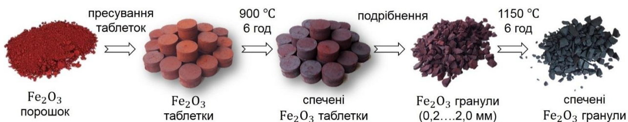
Рис. 4.1– Схема приготування гранул гематитового каталізатора.
