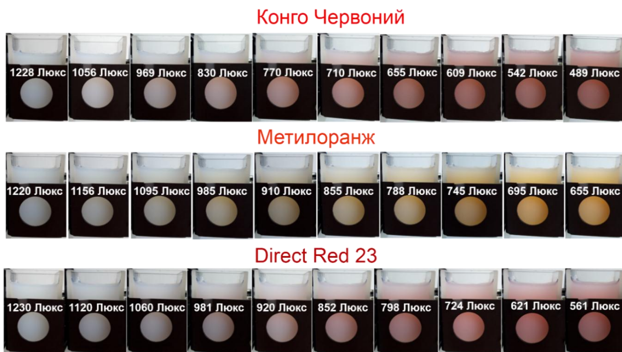
Рис. 5.10 – Зображення розчинів барвників із суспензіями фотокаталізатора P25-TiO 2 (0,5 г/л), використаного для калібрування. Концентрації барвників КЧ, МО та DR23 становили 0, 0.25, 0.5, 1.0, 1.5, 2.0, 2.5, 3.0, 4.0, 5.0 мг/л.
